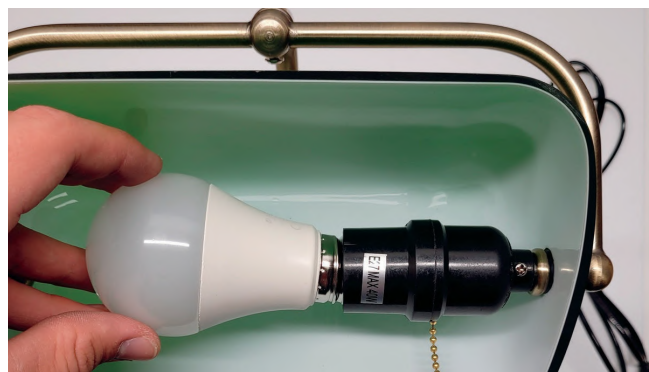
12. Dokręć żarówkę, rozłącz kabelek, a następnie przystąp do podłączenia do źródła prądu.
